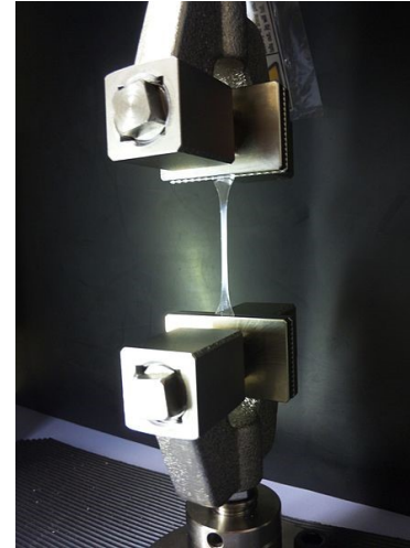
Polymer tensile test
